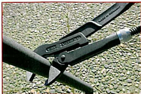
Einmal kurz andrücken und die Zähne der Zange graben sich in das Werkstück und ...
