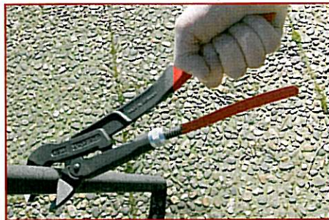
... die Zange kann durch ihren „Selbstklemmeffekt“ einhändig bedient werden
